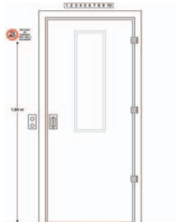
Figura 4 - Sinalização de elevadores (vista da escada)
